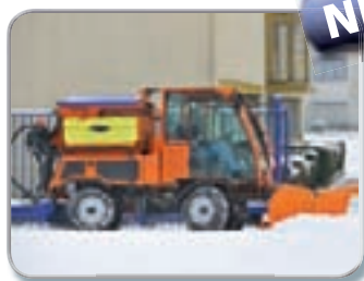
Multikoncept umožňuje například použití inertního posypu i postřik solanky od Küpper Weisser a šípového pluhu
