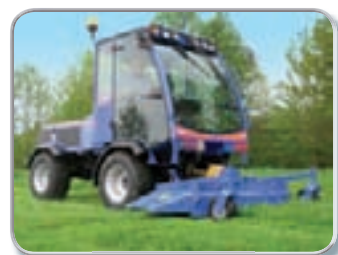
Žací lišta s bočním výhozem
