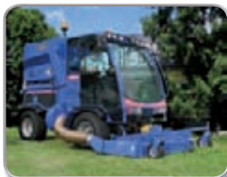
Plně hydraulický sběr trávy se sběrným kontejnerem o objemu 1600 litrů
