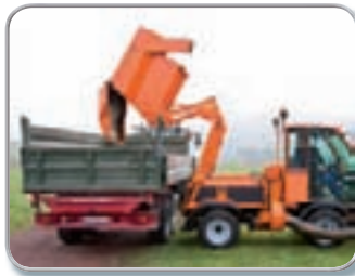
Vyprazdňování do výšky 230 cm a přesahem 50 cm
