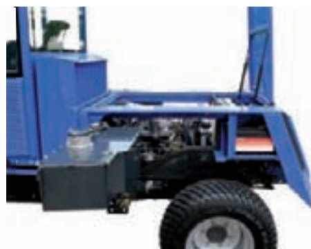
Obě nádrže na palivo i olej lze za účelem údržby jednoduše vykloupat ven.
