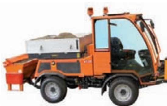
Praktické řešení – válcový sypač v kombinaci se sklopnou korbou
