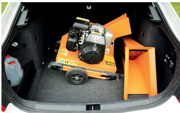
Po odejmutí trychtýře a sklopení kol a podstavce se štěpkovač Eliet Primo pohodlně vejde do zavazadlového prostoru osobního automobilu
