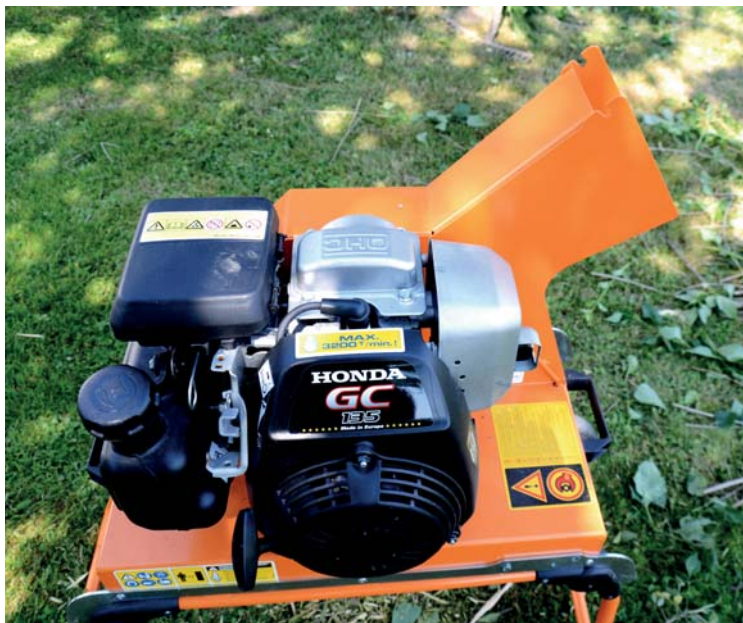
Stroj pohání motor Honda GC 135 o výkonu 4 k
