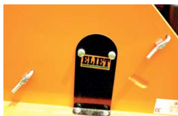
Síto je zajištěno závlačkami. Pokud byste je vyndali za provozu, štěpkovač se z bezpečnostních důvodů zastaví
