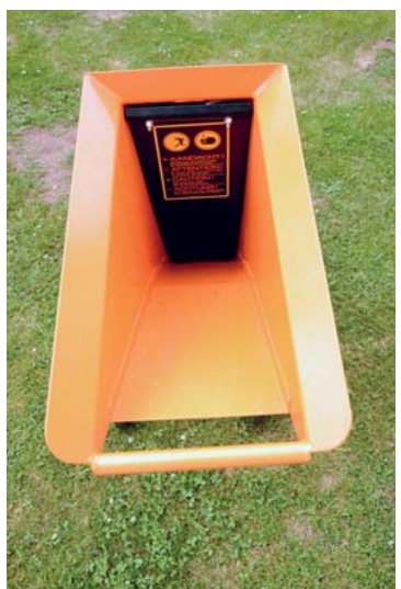
Kladem je velký vstupní otvor o rozměrech 20 x 40 cm. Pohyblivá klapka chrání obsluhu, madlo slouží k usnadnění přesunu stroje
