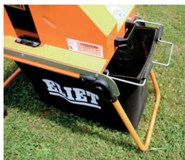
Plátěný koš o objemu 60 l se vsunuje do spodní strany štěpkovače. Zajištěn je pojistkou, při jejímž vyjmutí se vypne motor
