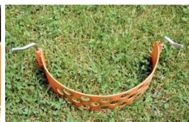
Síto je zajištěno závlačkami. Pokud byste je vyndali za provozu, štěpkovač se z bezpečnostních důvodů zastaví
