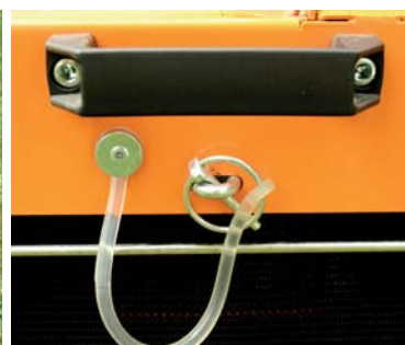
Plátěný koš o objemu 60 l se vsunuje do spodní strany štěpkovače. Zajištěn je pojistkou, při jejímž vyjmutí se vypne motor
