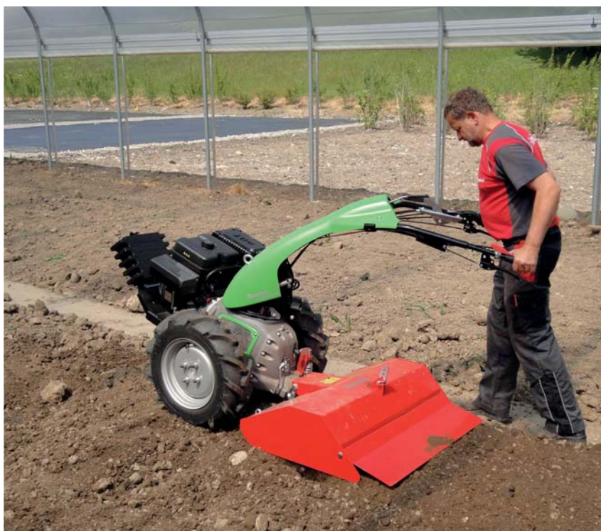
Princip práce rotavátoru
