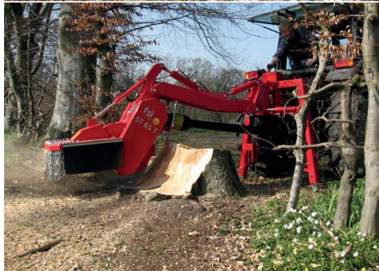
Frézy FSI bez vlastního motoru pracují v agregaci s traktorem nebo jiným nosičem náradí
