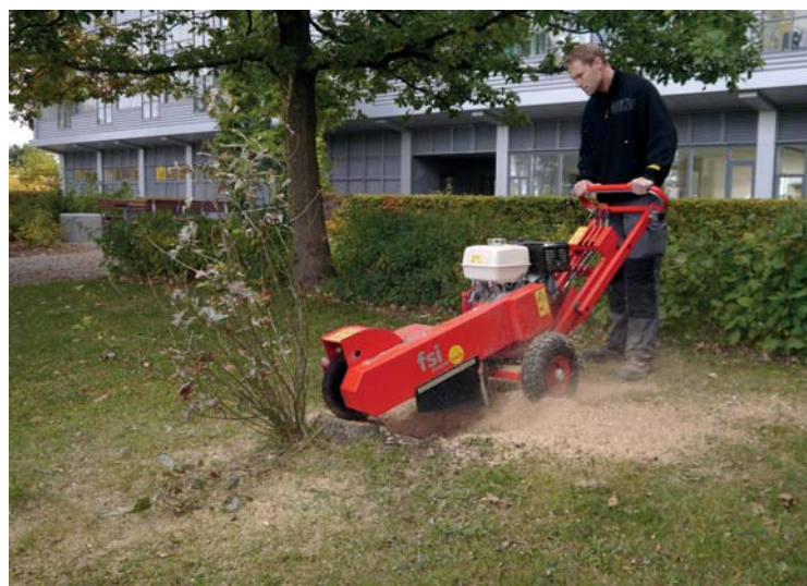
V sortimentu dánské společnosti FSI power-tech ApS jsou i ručně vedené pařezové frézy vybavené benzínovými motory
