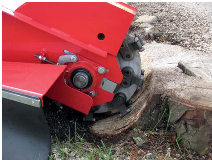
Řezné nože zajišťují maximální životnost při frézování také díky možnosti trojnásobného otočení polohy
