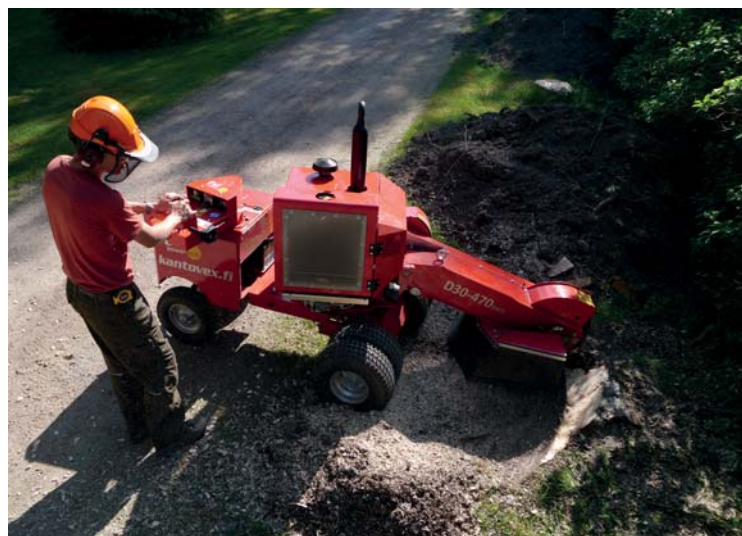
Samojízdná pařezová fréza FSI D30-470
