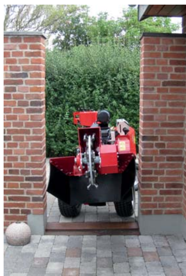
Dobrou průjezdnost zajistí šířka stroje, která je pouhých 80 cm
