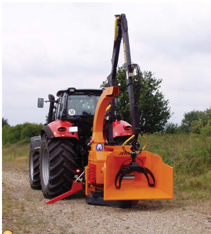
Na přání zákazníků lze ke strojům dodat podávací ramena
