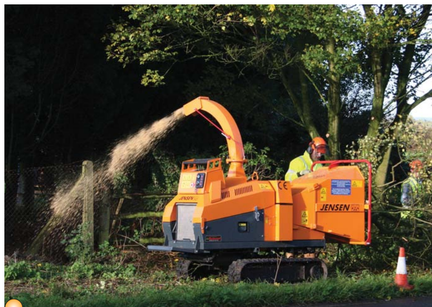
U štěpkovačů na pásovém podvozku lze upravit šíři rozchodu. Na přání je možné stroj vybavit systémem svahového vyrovnávání
