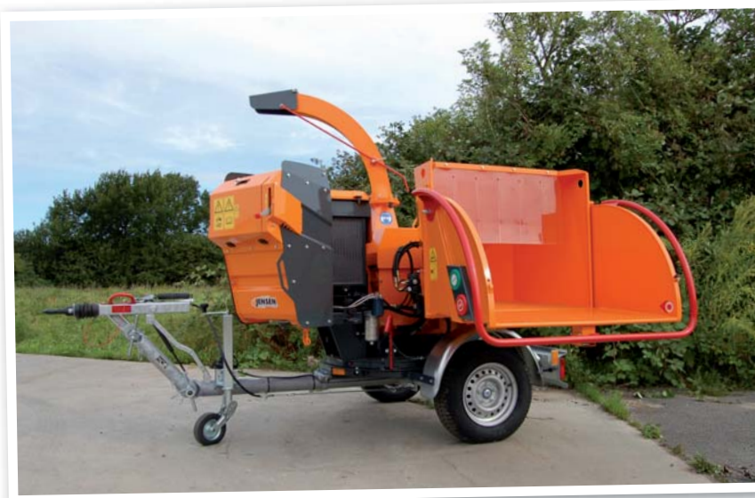
Novinkou je štěpkovač Jensen A540 New s motorem o výkonu 37 k na jednonápravovém podvozku. Poradí si s dřevní hmotou do průměru až 190 mm
