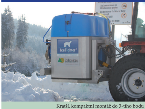
Kratší, kompaktní montáž do 3-tího bodu
