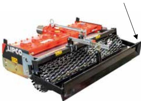
Hydraulische Tiefenregulierung über die Walze und hydr. Einstellung des Standard-Planierschildes
