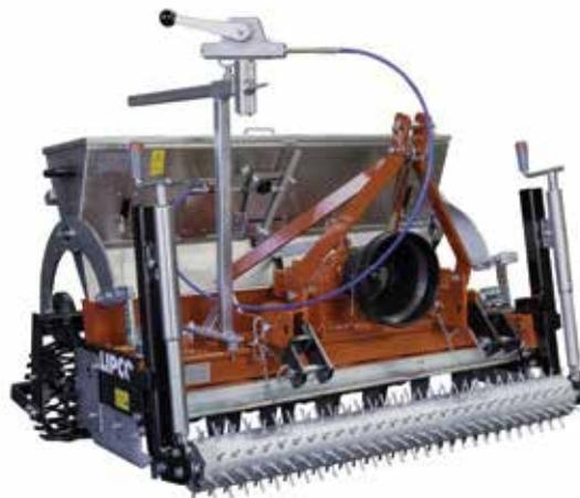
Foto: Uni-Kreiselegge UKD mit Sämaschine SMD und Igelwalze zur Nachsaat
