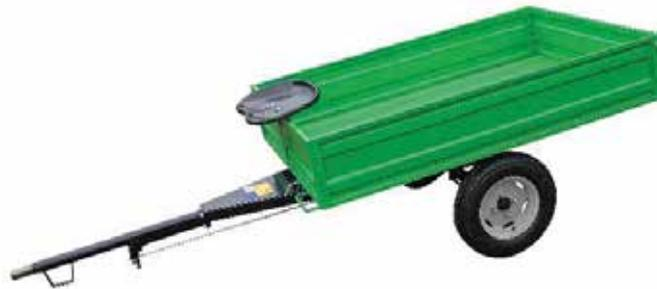
Anhänger darf nur an Antriebsfahrzeuge ohne Lenkbremse angehängt werden oder das Achsdifferential muss beim Anhängerbetrieb gesperrt sein.
