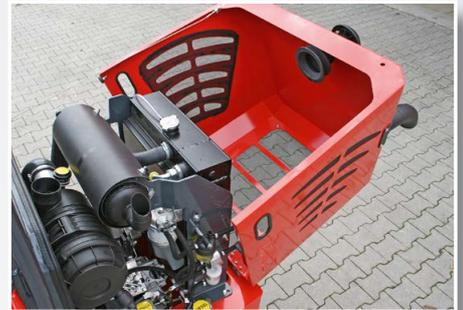
Die weit nach hinten schwenkbare Motorhaube, ermöglicht einfach die täglichen Wartungsarbeiten
