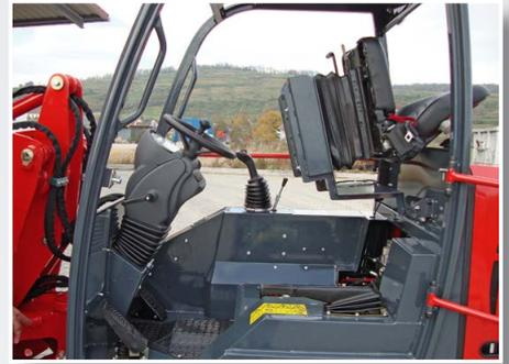
Für Reparaturarbeiten am Motor wird einfach die Sitzkonsole nach hinten geschwenkt
