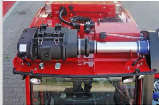
Der komplette Ansaugbereich, sowie die Luftfilteranlage befinden sich über der Fahrekabine
