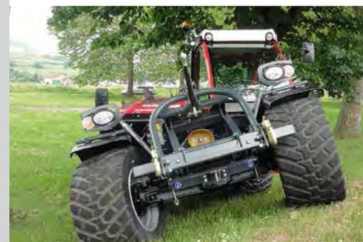
Das hochliegende Pendelgelenk verleiht dem Fahrzeug eine hohe Kippstabilität. Die Anordnung des Pendelgelenks ermöglicht der Vorderachse einen extrem großen Pendelweg
