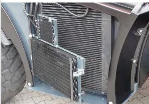
Seitlich angeordnetes Kühlerpaket ermöglicht die einfache Reinigung durch werkzeugloses Wegschwenken der einzelnen Kühlersegmente
