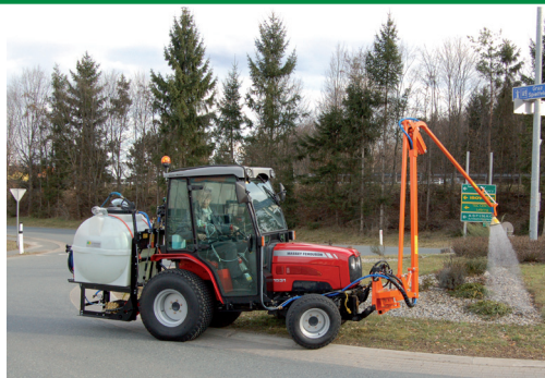
Zavlažovací rameno se zařízením ECO-Multiwash
