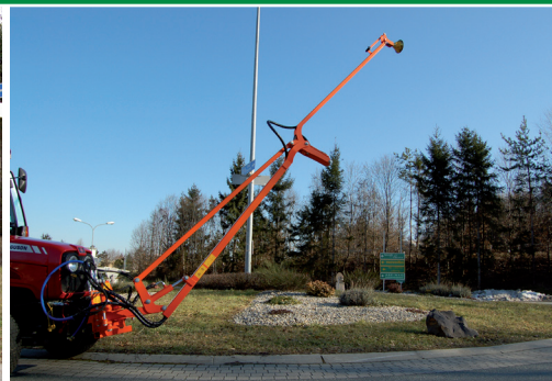
Zavlažovací rameno v max. pozici pro závěsnou zeď
