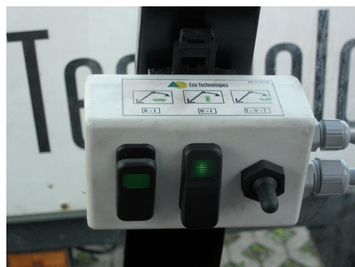
Ovládání pohodlně s kabiny – varianta s jedním DW okruhem
